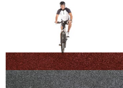
PYÖRÄKAISTAT Pyöräkaistalla punainen asfaltti erityistä huomiota vaativissa paikoissa. Erotus ajoradasta upotetulla 22 cm reunatuella, reunatuen materiaalina harmaa graniitti.
